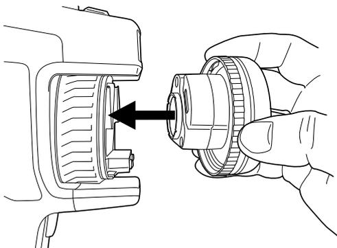
6. Faites pivoter l'anneau intérieur à 30° dans le sens horaire. L'objectif émet un déclic lorsqu'il est verrouillé dans son emplacement.
