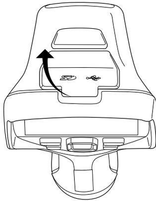
2. Connectez le câble USB sur le connecteur USB-C de la baie de connexion et sur l'ordinateur.
