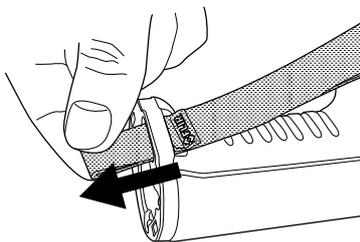
4. Tirez sur la dragonne de poignet à travers le point d'attache jusqu'à la butée.
