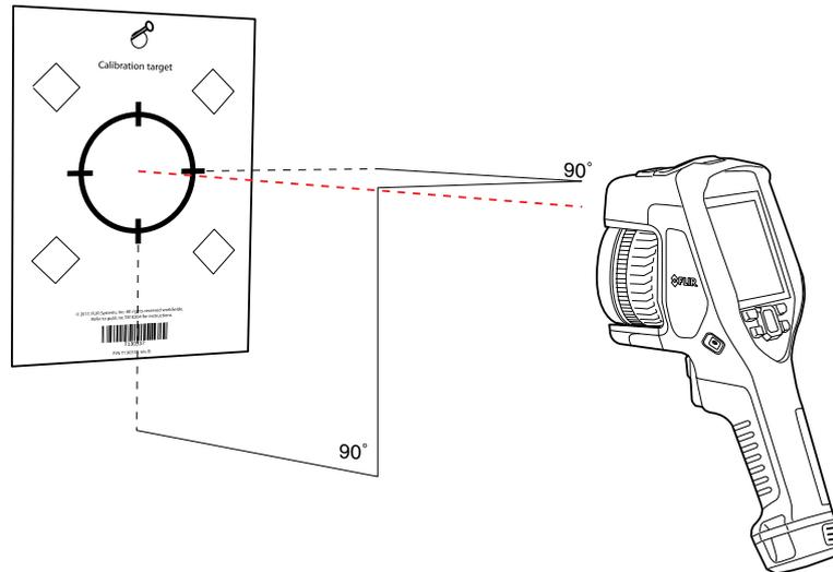
5. Sur la caméra, alignez les images thermiques et visuelles (indiquées par les deux carrés sur l'image ci-dessous) au moyen des flèches de l'écran tactile. La combinaison de caméras à objectif est ainsi étalonnée.
