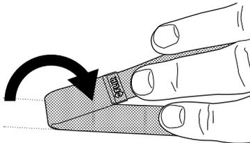
3. Faites passer la dragonne de poignet repliée à travers le point d'attache à la base de la caméra.
