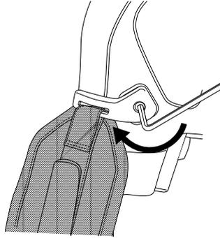
3. Faites passer la sangle à travers le point d'attache à la base de la caméra. Sécurisez la sangle avec la fermeture de type velcro.
