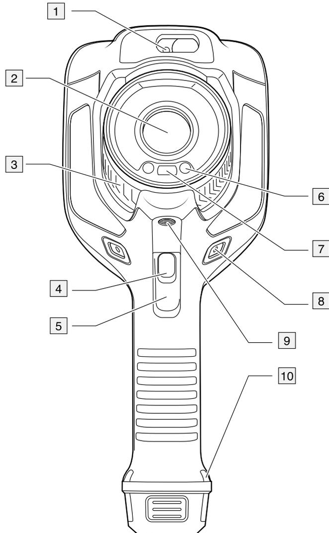
1. Laser de mesure de la distance.<sup>1</sup>
